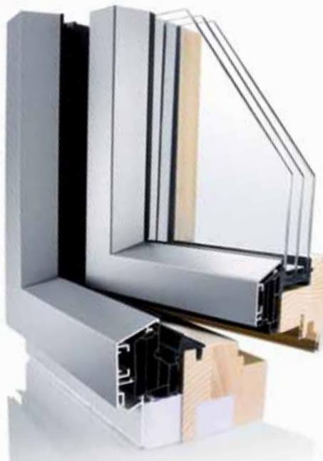
Mira Therm (78 oder 90) ist ein wärmegedämmtes Holz-Aluminiumsystem. Das System zeichnet sich durch eine erhöhte Oberflächentemperatur im Glasrandbereich des Fensterflügels innen und im Bereich des Bauanschlusses aus.
