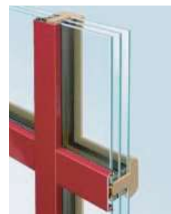
Glasteilende Sprosse (Holz-Alu) 3-fach-Glas Sprossenbreite 64 mm (Optional 82,110 mm)
