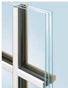
Aufgesiegelte Sprosse (Wiener) 3-fach-Glas Sprossenbreite 26 mm (Optional 36 mm)
